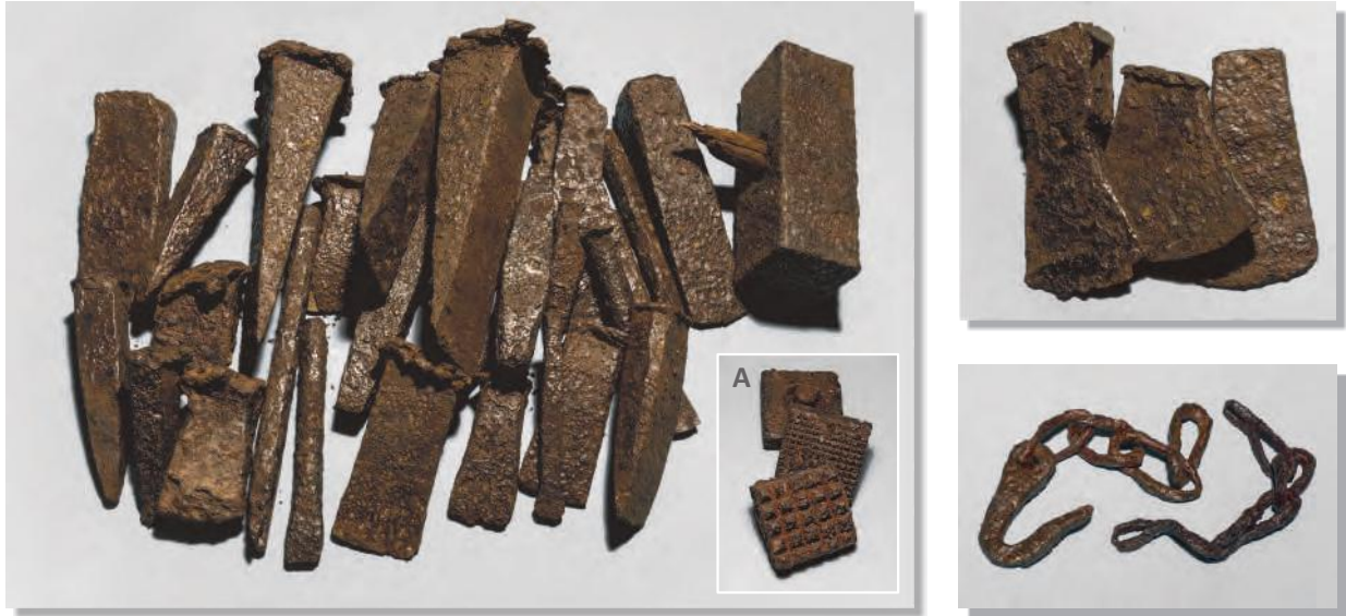
Abb. 155 - 157: Utensilien für Granitabbau und Forstwirtschaft: Meißel, Spaltkeile (19./20. Jh), Stockhammerplatten (A, 20. Jh.), 1 Axt- und Kettenfragmente
